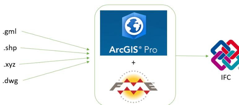
Abbildung 2: Konvertierung unterschiedlicher Datenformate in das IFC-Format mittels ArcGIS Pro und FME, zur Darstellung im BIM-Gesamtmodell
