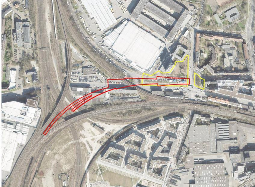
Abbildung 1: Footprint des geplanten Abzweigbauwerks (rot) mit BE-Flächen (gelb). Luftbild: DOP20 - Freie und Hansestadt Hamburg, Landesbetrieb Geoinformation und Vermessung (LGV).
