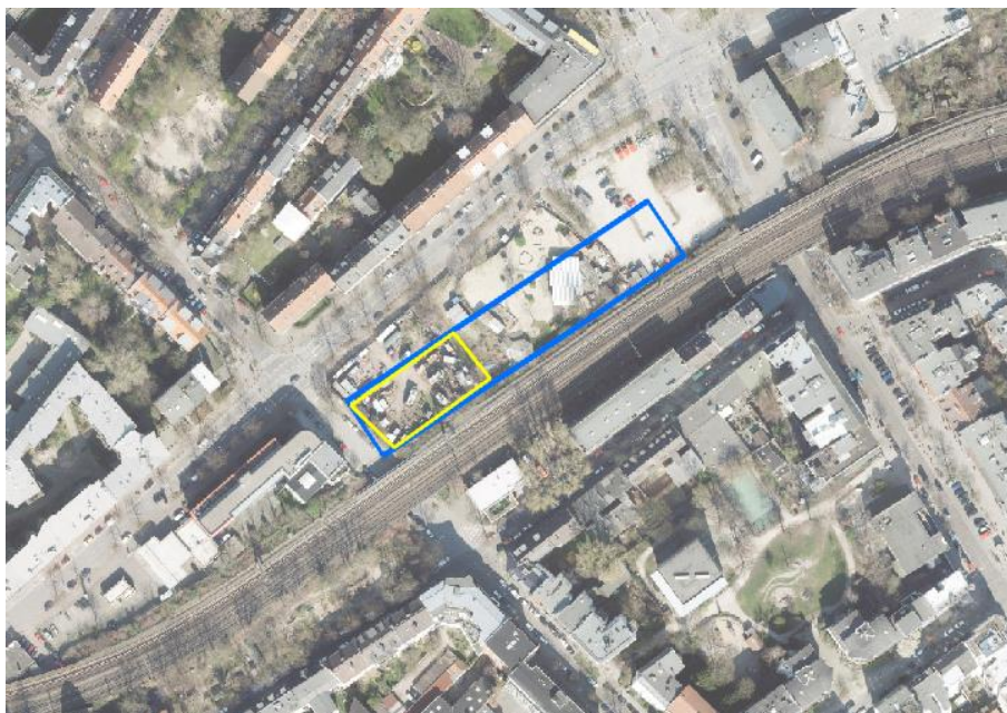
Abbildung 1: Footprint der Kreuzweiche (blau) (3+620 bis 3+765) zwischen den Stationen Sternschanze I und Holstenstraße I mit BE-Fläche (gelb). Luftbild: DOP20 - Freie und Hansestadt Hamburg, Landesbetrieb Geoinformation und Vermessung (LGV).
