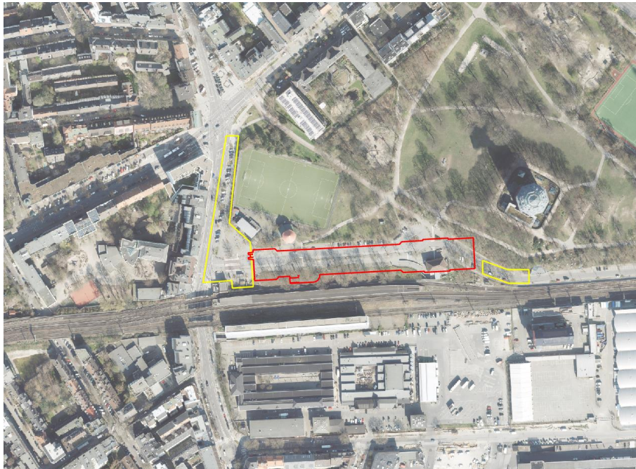
Abbildung 1: Footprint der Station (rot) mit BE-Flächen (gelb). Luftbild: DOP20 - Freie und Hansestadt Hamburg, Landesbetrieb Geoinformation und Vermessung (LGV).
