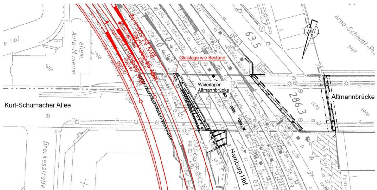
Abbildung 113 Lageplan Variante 2 Bereich Widerlager Altmannbrücke
