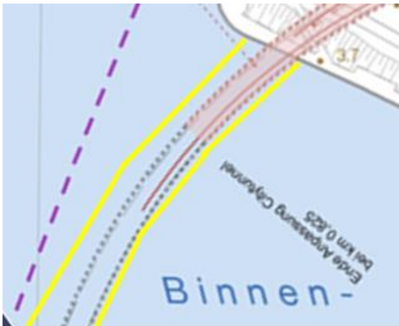
Abbildung 279: Nötige Spundwände in der Binnenalster für das spätere Offenlegen der Tagbaustrecke
