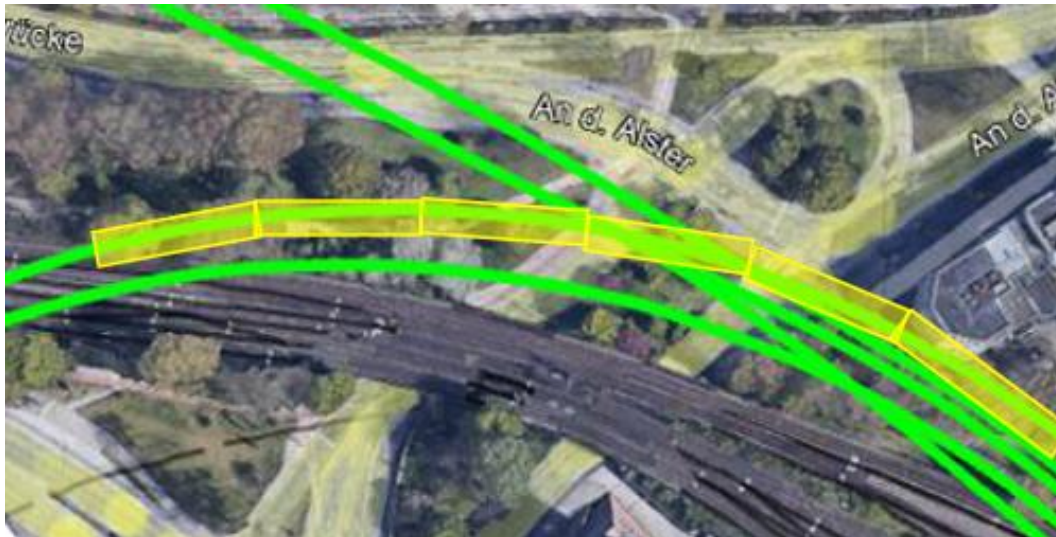
Abbildung 278: Strecke der neuen City-Tunnel-Nordröhre, welche in der ersten Bauphase hergestellt wird (gelbe Strecke). [basierend auf: Bilder © 2023 CNES / Airbus, GeoBasis-DE/BKG, GeoContent, Maxar Technologies, Kartendaten © 2023 GeoBasis-DE/BKG (©2009)]
