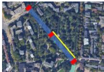
Abbildung 133 Bergmännische Station mit zusätzlichem Schacht in der Parkmitte
