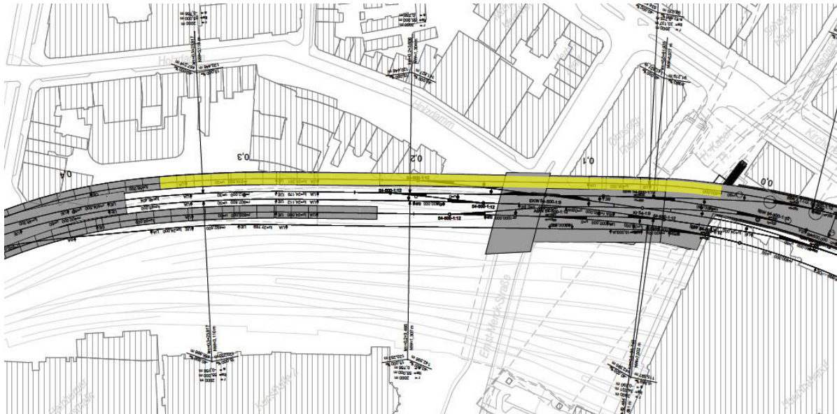
Abbildung 280: Neu zu erstellender Gleisbereich im Nordkopf des Hauptbahnhofs als Zulauf zu den Gleisen 1 und 2
