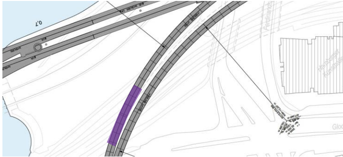
Abbildung 266: Neue City-Tunnel-Röhre unter dem Bahndamm
